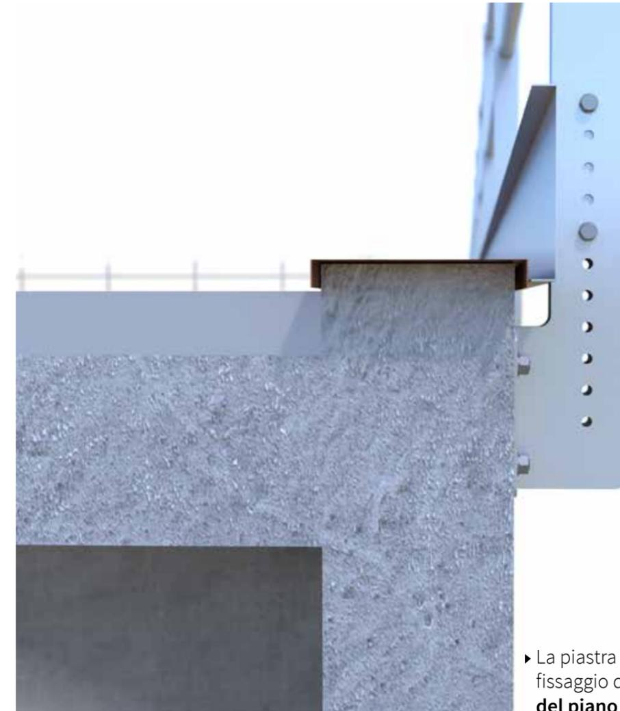
► La piastra WALL permette il fissaggio del parapetto al di **sotto** del piano di calpestio.
