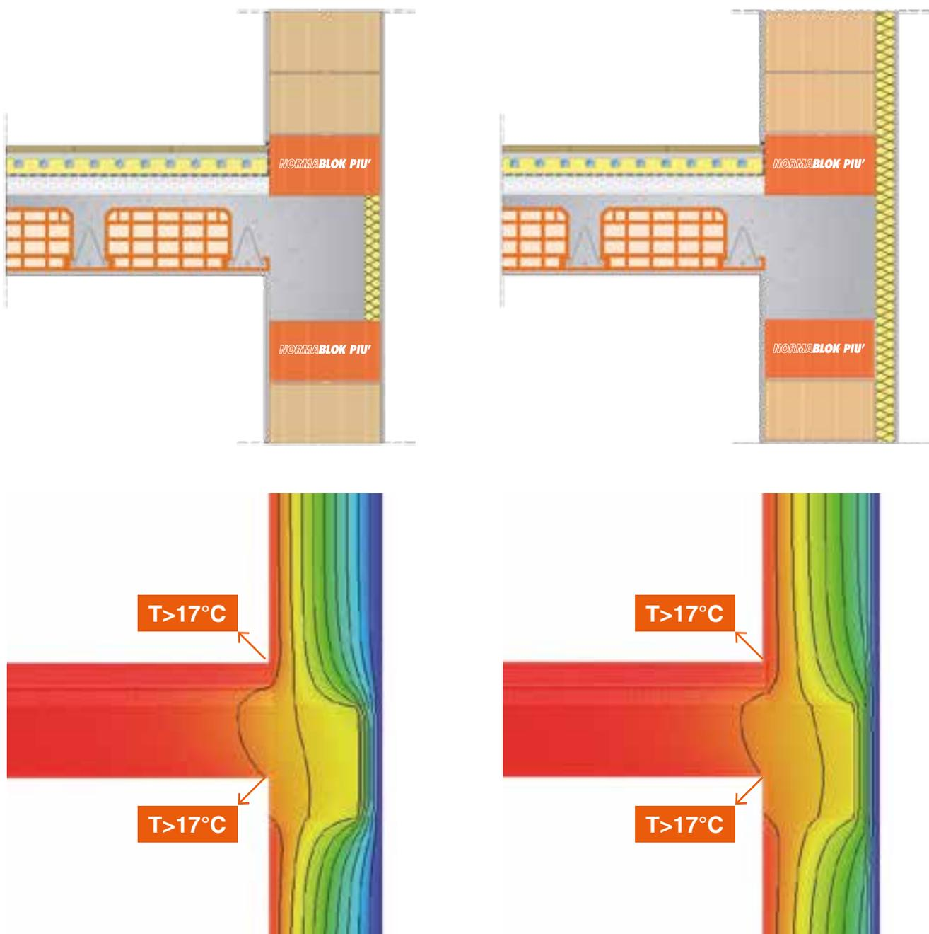
**Blocchi Normablok Più Taglio Termico si impiegano ovunque sia necessario isolare termicamente la muratura dalla fondazione e dal solaio.**
