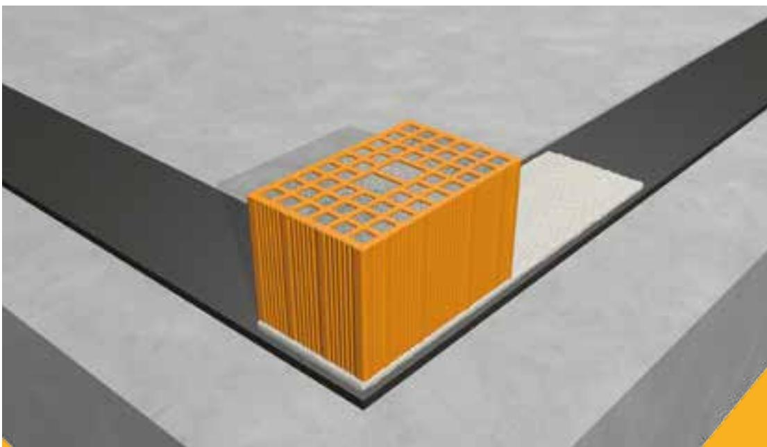
Applicata un'ideale guaina impermeabilizzante dove richiesto, posare il corso di **blocchi Normablok Più** realizzando i giunti con malta di allettamento tradizionale. Nel caso di blocchi Normablok Più ad incastro realizzare solo il giunto orizzontale.
