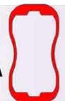
**NUOVO MONTANTE INFINITY** dall'ergonomia sorprendente. La sua **geometria sperimentale brevettata** ne aumenta la **RESISTENZA** del **17%**, rispetto ad una geometria tradizionale. Il montante è in alluminio con **TECNOLOGIA SNAP FIT**. L'interasse tra montanti può arrivare fino a **2,5 m** e l'altezza di ogni singolo montante fino a **1,5 m**, rispettando gli standard di prodotto. Permette di risparmiare il **50%** del tempo di assemblaggio.
